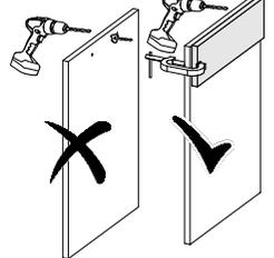
Досверлить отверстия внутренней стороны сверлом 5мм.
